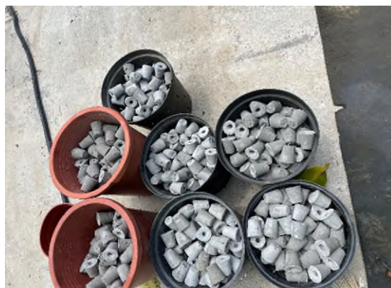
照片 4 珊瑚移植磚基座製作完成
