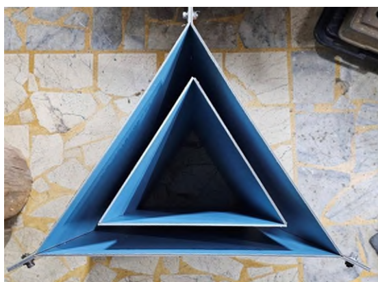
照片 1 珊瑚移植磚水泥模具製作
