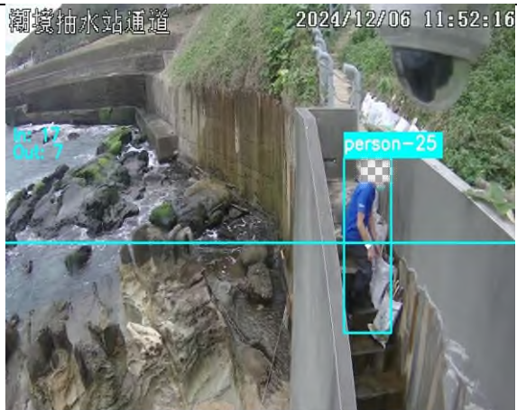
於單一出入口管制架設攝影機，以 AI 監控的方式隨時掌握人員進出狀態，達到管制人數的效果。
